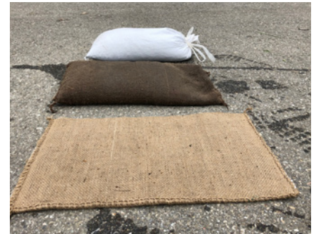
Das Bild zeigt oben in Weiss einen alten herkömmlichen Sandsack, in der Mitte einen aufgeblähten neuartigen Granulatsack und unten denselben Granulatsack in seinem trockenen und schlanken Zustand.
